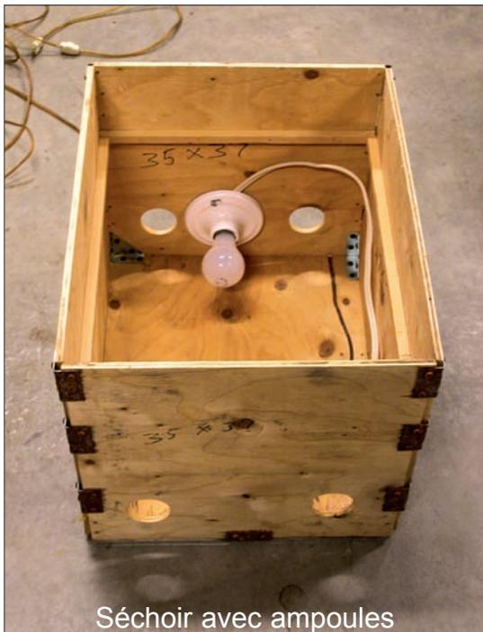
Séchoir avec ampoules
